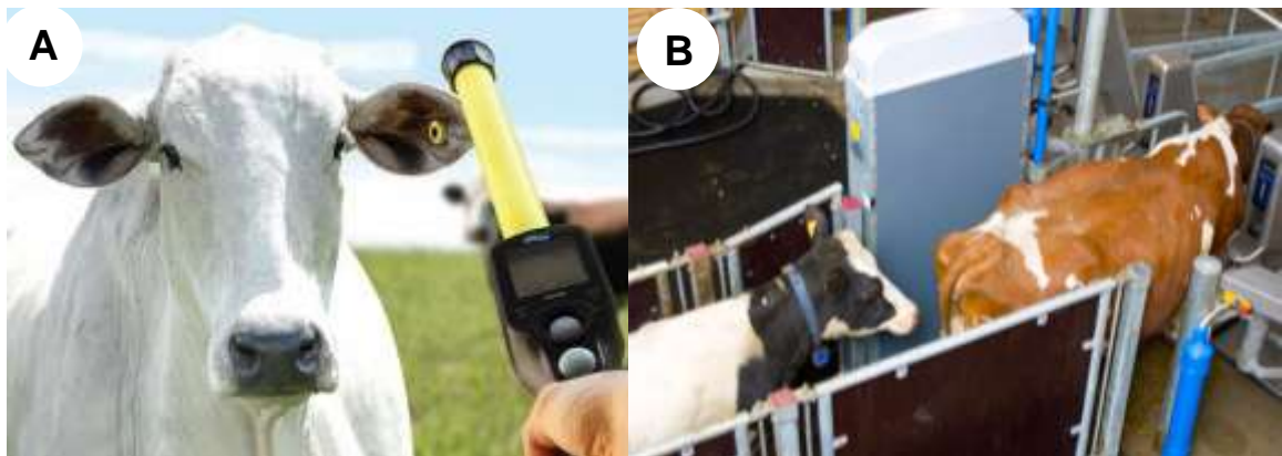
Figura 10. Leitora portátil (A) e leitora fixa (B) de brincos e bottons eletrônicos
