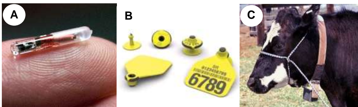
Figura 9. Transponder injetável (A), brincos eletrônicos (B) e colar (C)
