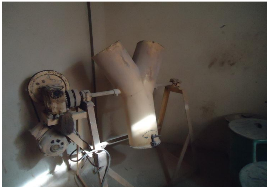
Figura 6. Misturador Y dos microminerais na fábrica.
