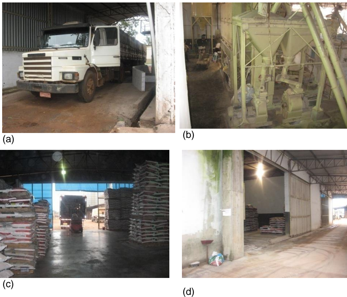
Figura 1. Estrutura da fábrica: (a) recepção de matéria prima; (b) produção; (c) área de estocagem; (d) expedição de produto.
